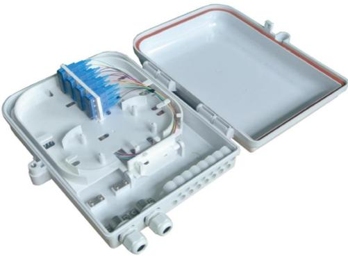
Оптический кросс с защитой от попадания влаги IP67 с возможностью установки внутри сплиттера с коэффициентом деления до 1x16. Имеет внутри кронштейн для установки 16 адаптеров типа SC, а также кассета для размещения 20 гильз КДЗС и выводов сплиттера. Кросс имеет 2 ввода для кабеля диаметром до 12мм и 16 выводов под дроп-кабель. Кросс предусматривает установку как внутри помещений, так и вне помещений в уличных условиях.
